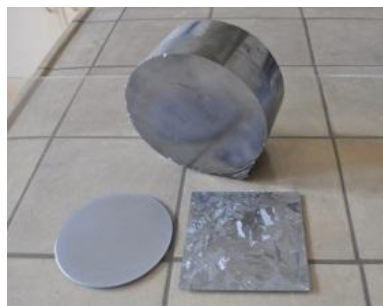
cięcie piłą diantentową
