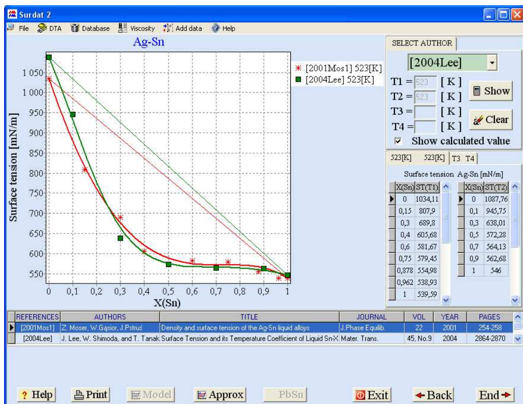
Rys. 6.46. Izotermy napięcia powierzchniowego układu Ag-Sn policzone dla wybranej temperatury (523 K) opracowane przez dwóch autorów prac i porównane z danymi doświadczalnymi
