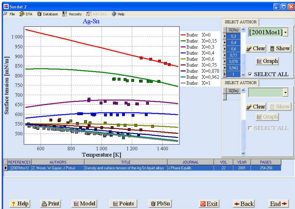
Rys. 6.50. Zależności temperaturowe napięcia powierzchniowego ciekłych stopów Ag-Sn wyliczone z modelu Butlera i porównane z danymi eksperymentalnymi
